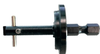
Rysunek 3.1-3: Sprzęt do zgrzewania kołków – część II
