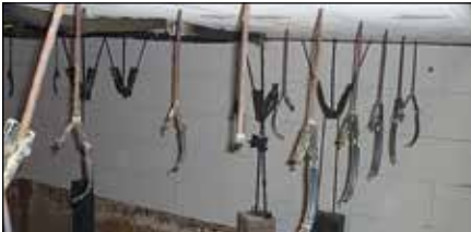
Rohrschellen nach der Brandprüfung, Versagen im Verschlussbereich
