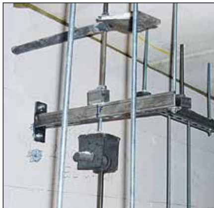
Konsole MQK mit mittiger Einzellast, vor der Brandprüfung
