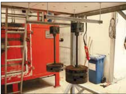
Brandtest MM-C Schienen mit Einzellast
