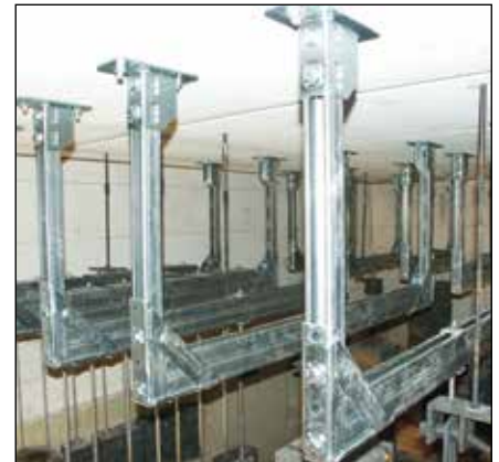
U-Joch mit Einzellast bzw. Mehrfachlast vor der Brandprüfung
