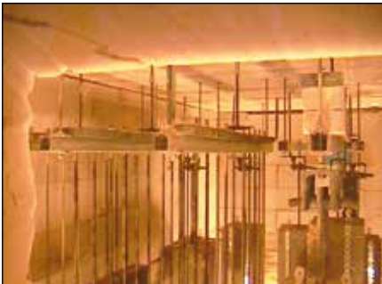
Abgehängte Montageschiene MQ mit Gleichlast, unmittelbar nach dem Start der Brandprüfung
