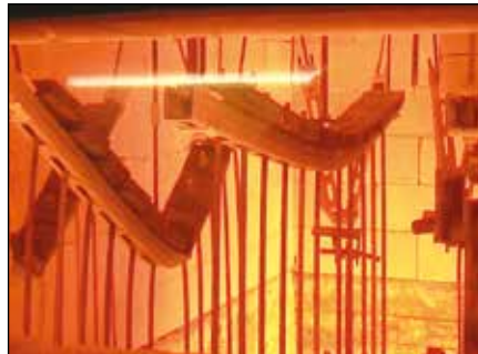
Deutliche Verformung der Schienen unter Brandbeanspruchung, abhängig von der aufgetragenen Last und Branddauer
