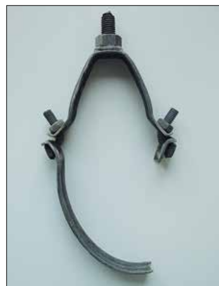
Rohrschelle nach der Brandprüfung, Abriss Schellenband
