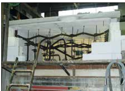
Mehrfelddurchlaufträger-Systeme mit Einzel-lasten, nach der Brandprüfung
