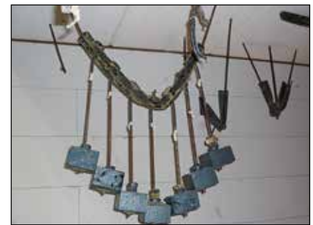
Abgehängte Montageschiene MM-C mit Mehrfachlast nach der Brandprüfung
