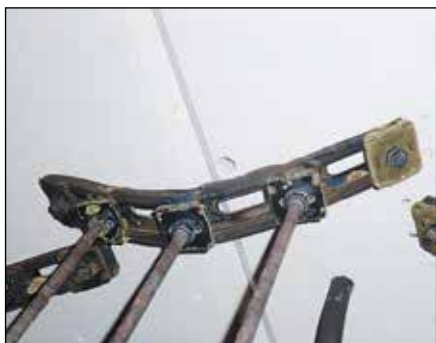
Direktmontierte Schiene MQ-21, Stützweite 350 mm, 3 Einzellasten
