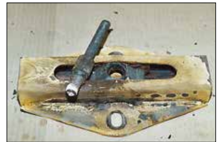
Versagensart: Auszug der Gewindehülse aus dem Schlitten
