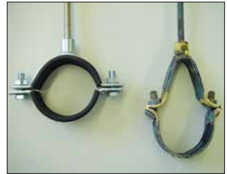
Rohrschelle MP-MXI vor und nach der Brandprüfung
