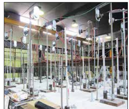
Elektronische Verformungsmessung auf der Decke des Brandofens
