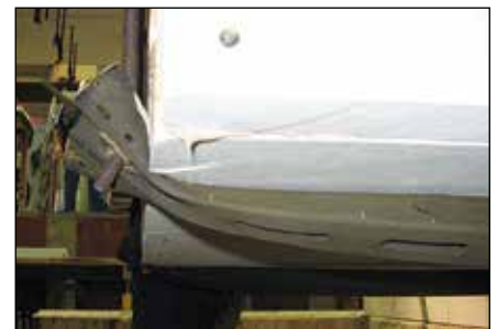
Starke Verformung der Tragschiene im Eckbereich, die Gewindestangen liegen am Kanal an, darüber hinaus kaum Verformung der Tragschiene
