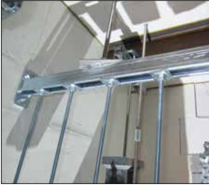
Konsole MQK mit Mehrfachlast, vor der Brandprüfung
