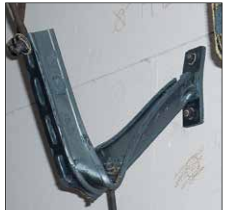
Konsole MM-B mit mittiger Einzellast, nach der Brandprüfung
