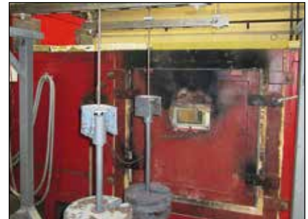
Abgehängte Montageschiene MQ mit mittiger Einzellast, vor der Brandprüfung
