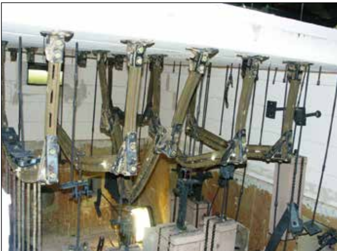
U-Joch mit Einfach- bzw. Mehrfachlast nach der Brandprüfung
