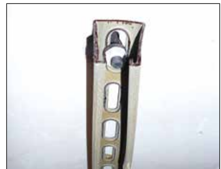
Schiene MM-C, mit mittlerer Einzellast, geringe partielle Verformung nach dem Versagen der MM-S
