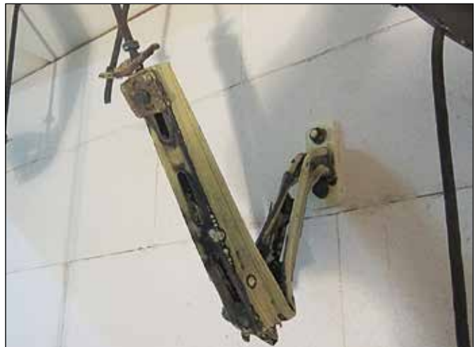
Konsole MQK mit mittiger Einzellast nach der Brandprüfung
