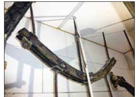
MQ-41, abgehängte Montage, 3 Einzellasten, MQA unterseitig montiert
