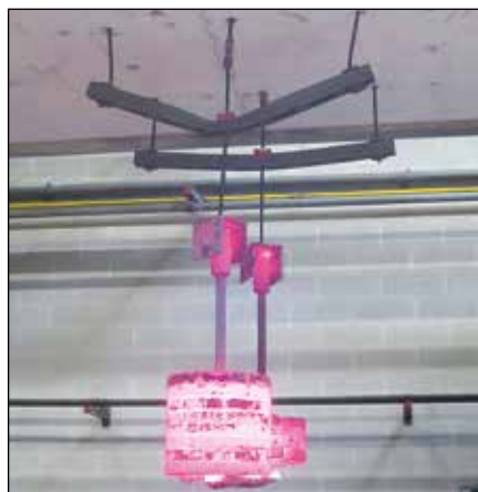
Abgehängte Montageschiene MQ mit mittiger Einzellast. Die mittige Gewindestange dient der Verformungsmessung
