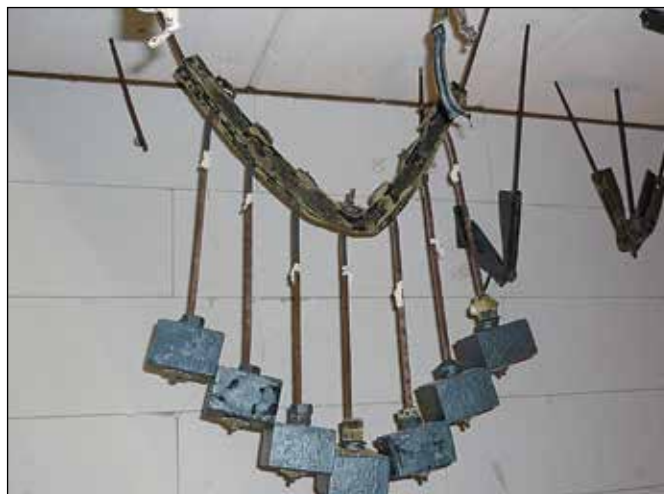
Abgehängte Montageschiene mit Mehrfachlast nach der Brandprüfung
