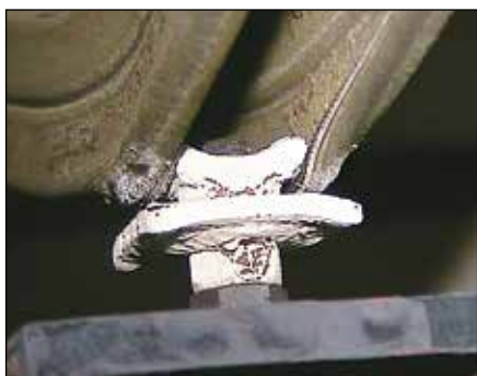
Verformung von MQA-B und Schiene MQ-41, kurz vor dem Versagen
