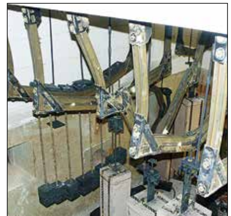
U-Joch mit Einzellast bzw. Mehrfachlast nach der Brandprüfung
