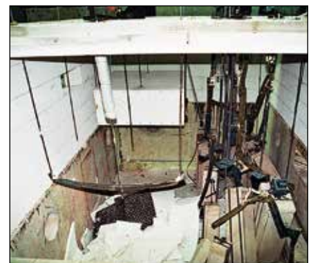
Blick in den Brandraum nach Ende einer Brandprüfung
