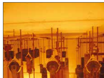
MP-MXI Rohrschellen, Blick in den Brandofen nach Beendigung der Brandprüfung
