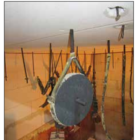
Rohrschelle MP-MXI mit Rohrdummy nach der Brandprüfung
