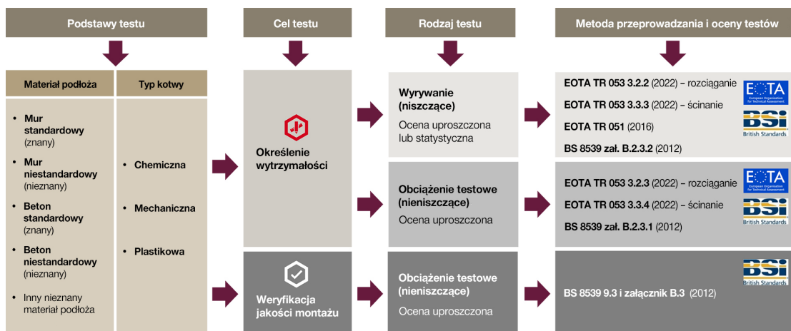
Rys. 2 Propozycja Hilti dotycząca wykonania testu i metody oceny w oparciu o materiał podłoża, typ kotwy oraz cel i rodzaj testu na budowie.
